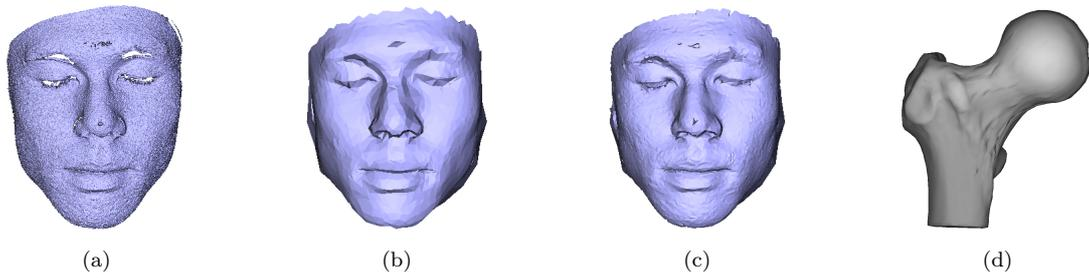
図 5 SDM からの対象物表面の復元: (a) 顔の計測データ; (b) レベル 4 の SDM の変形によって復元された顔モデル; (c) レベル 5 の SDM の変形によって復元された顔モデル; (d) レベル 5 の SDM から得られた骨モデル.
