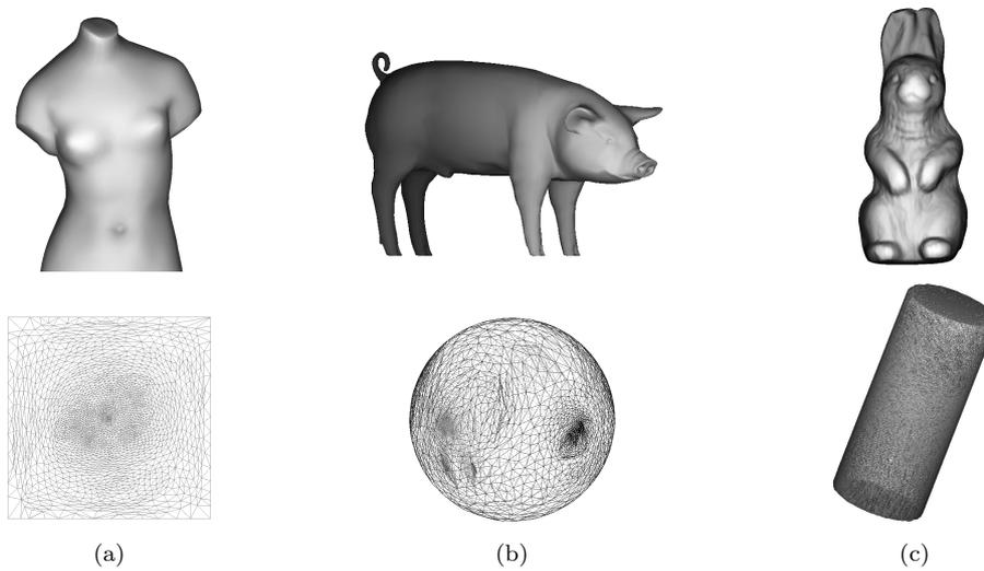
図 6 物体のメッシュモデルを初期 SDM とした写像面への投影; 上段:初期 SDM であるメッシュモデル (a) 体の彫像, (b) 豚, (c) 兎; 下段:投影したメッシュモデルであり, 対象曲面はそれぞれ (a) 平面, (b) 球面, (c) 円柱表面.
