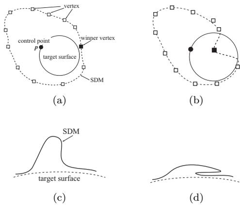
図4 SDMの不適切な変形例: (a-b)対象曲面内部へのSDMの侵入; (c-d)SDMの折り重なり.
