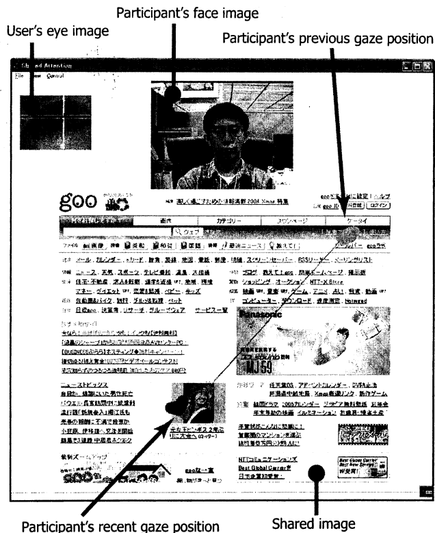
図 4: 視線と頭部情報を伝達するコミュニケーションシステム、視線情報は一定時間の視線データが連続する線分として、頭部方向情報は画面上部に表示された静止画として表現されている。また、視線測定の確認用に、利用者の眼球像が表示されている。
