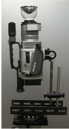
図 5 回転盤を設置したカメラ
