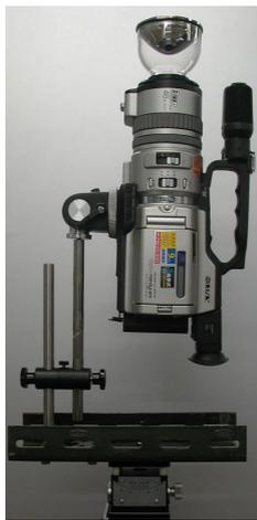
図 6 傾き盤を設置したカメラ
