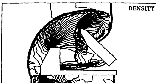
図-18 非構造格子の解適合格子法 19)
