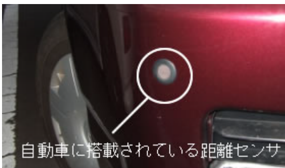
図1 自動車の距離センサ
