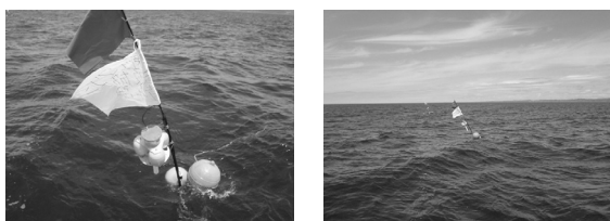
図 10 5 層計測式プロトタイプブイ (usuya02)
