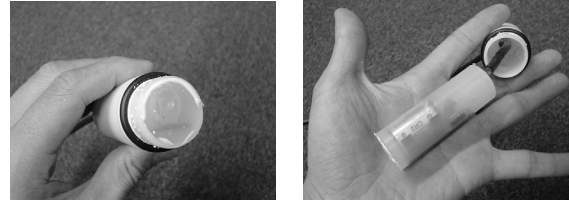
図 5 水温計のシリコンモールド
