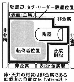
図4 洗面所の構成材料の概略.
