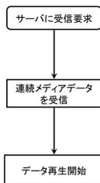
図 2 クライアント側の受信フローチャート (オンデマンド型)
