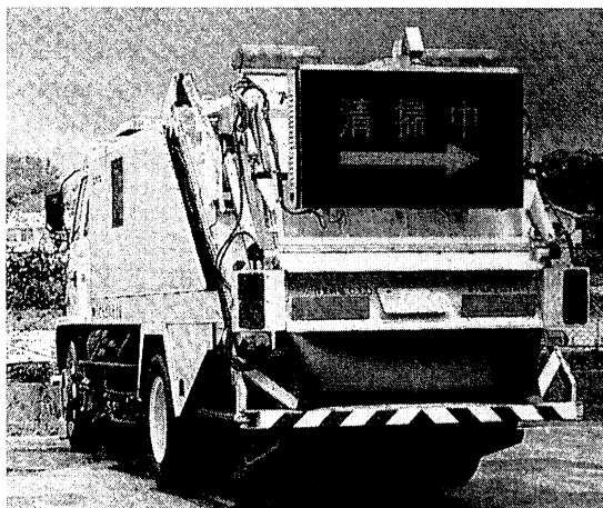
図 1 LED 式車載標識装置を搭載した作業車の例
