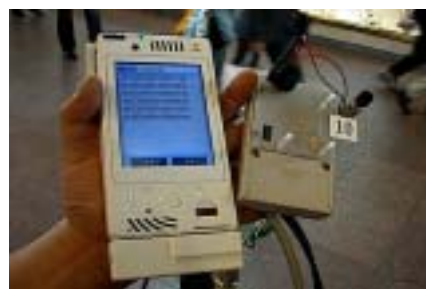
図 5: 歩行者端末: ユビキタスコミュニケーターに接続した ZigBee 対応無線センサー端末
