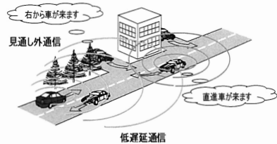
図2 車車間通信の安全運転支援アプリケーション例。
