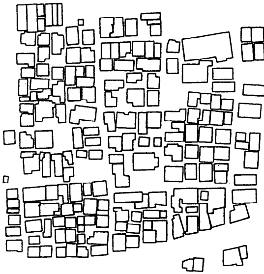
(b) 自動ベクトル化の結果 (建屋図形)
