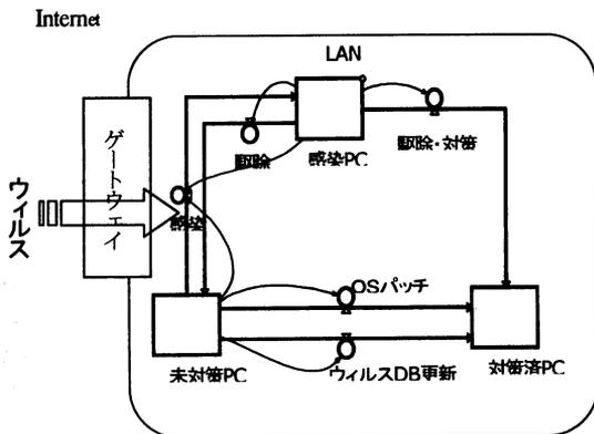
図2 感染拡散・制御の基本モデル
