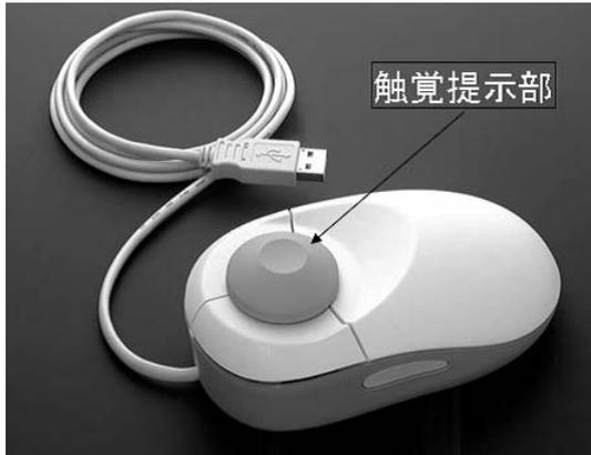
図 1: 2次元動作型触覚提示装置
