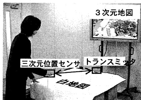
図5 磁気センサを利用した3次元地図上での位置入力
