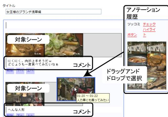
図 5: ドラッグアンドドロップ型の映像レビュー記事の編集インタフェース。過去に投稿したアノテーション履歴から、任意の複数のショットを選択し、対応するコメントの編集も可能である。
