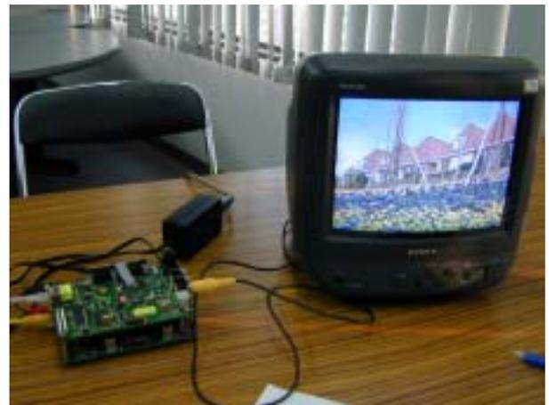
図 5 評価ボードによる MPEG-2 デコード処理
