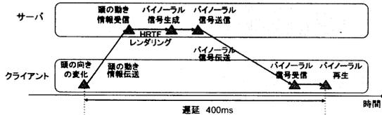
サーバが位置情報を受信してから、ユーザ側で再生されるまでに、ユーザの頭の向きが変化するため、仮想音源からユーザに対する信号到来角度が変化する
