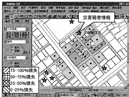
図7 火災延焼シミュレーションと災害弱者の位置
