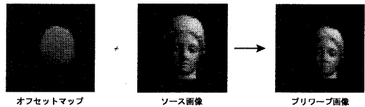
図 10: オフセットマップを使用したソース画像からのプリワーピング画像の生成
