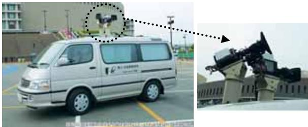
図1 計測専用車輛(タイガーアイ)
