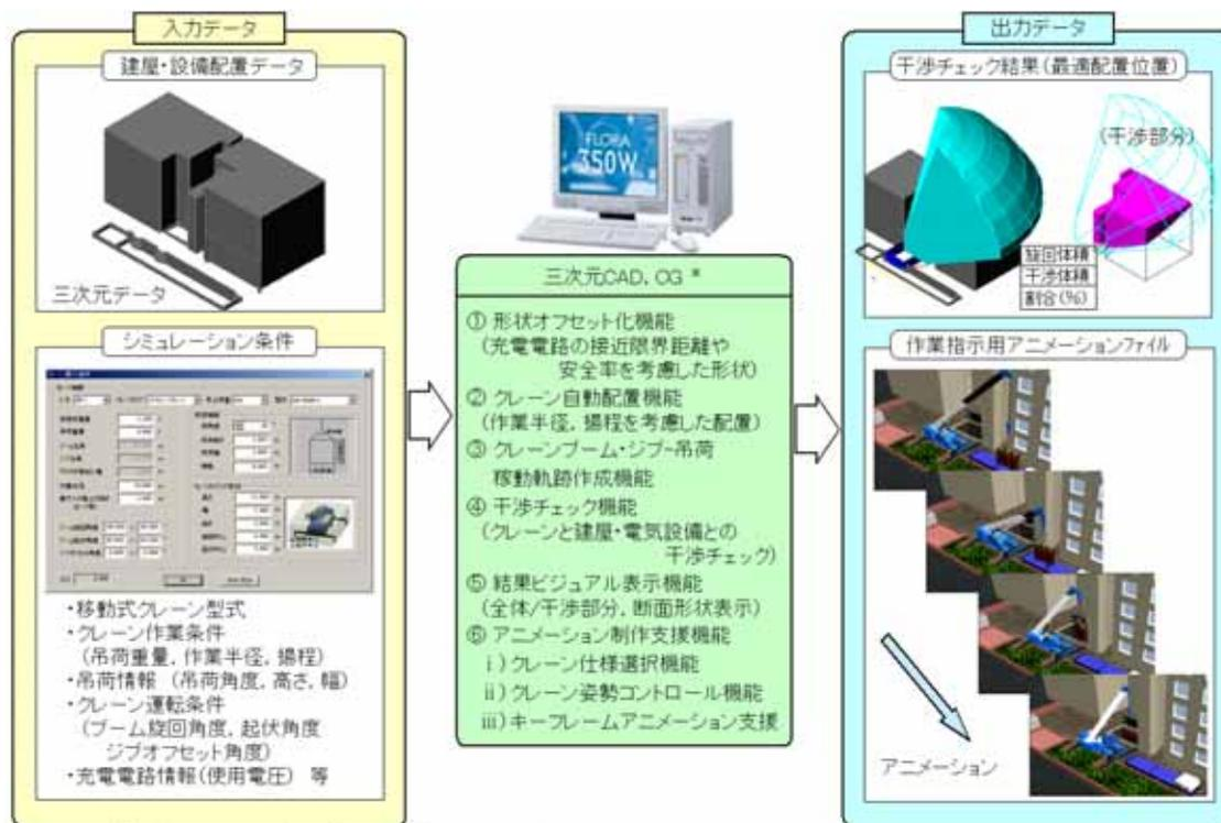
図1 移動式クレーン用搬入計画支援システムの概要
