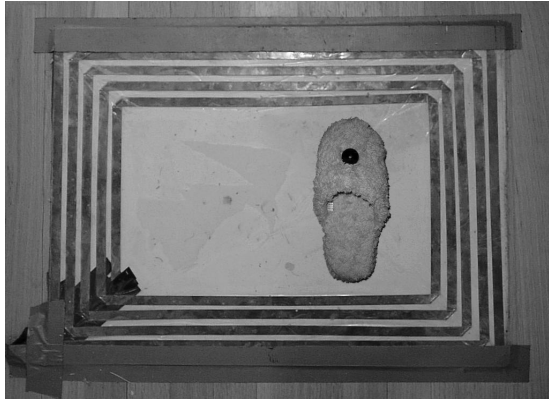
図 3: RFID を取り付けたスリッパと、読み取りアンテナ。
