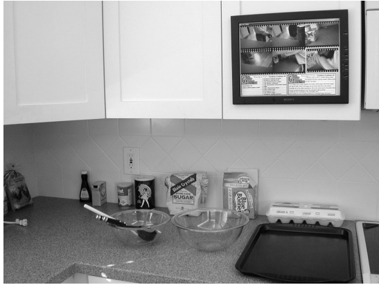
図 4: Cook's Collage. キッチンキャビネットの下に 4 個のカメラがあり、調理台の作業のスナップショットがディスプレイに表示される。
