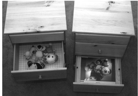
図 7: Peek-A-Drawer . ネットワーク接続したキャビネットの上の引き出しの内容が、もう一方の下の引き出しのディスプレイに表示される。
