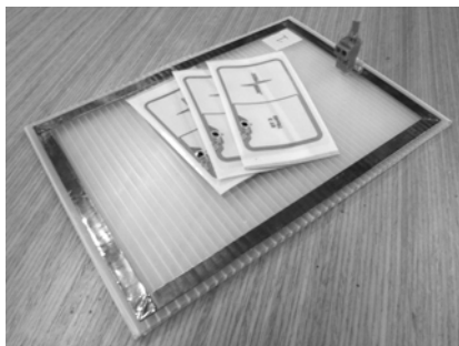
図 4. 積層 RFID のアンテナ部分とタグ
