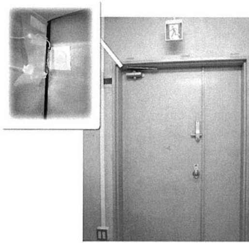
図 6: 研究室のドアにリードスイッチを取り付けた
