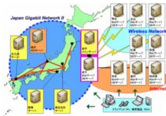
図 7: プロトタイプシステムネットワーク図
