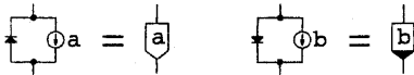
図3 図2における電流制限器の構造 Fig. 3 The structure of current limiter in Fig. 2
