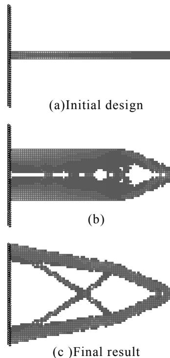
Fig.9 変位制約のある片持ち梁構造の生成
