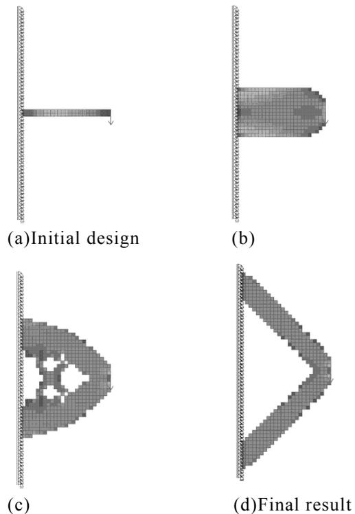
Fig.6 二部材フレーム構造の生成
