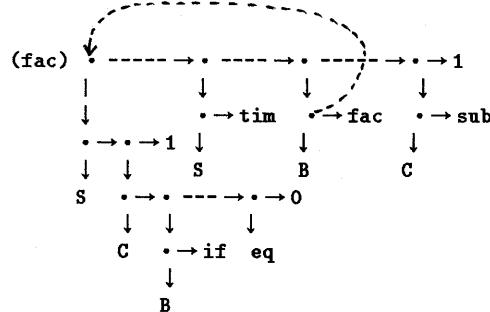
このとき Turner[5] を注目したいのは、再帰呼出し fac の表現として、左上角の点（即ち、fac プログラム本体の根）への有向辺（ポインタ）というサイクル構造を用いていることである。（上図の点線矢印を参照のこと。）
