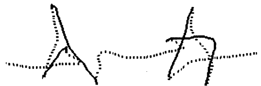
図1 ストロークデータの実例。実線は実画、破線は虚画をそれぞれ示す。
