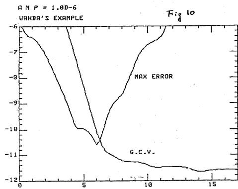
Fig. 7~10. は、比較的ノイズレベルが小さい ( $10^{-5} \sim 10^{-6}$ ) 場合の数値結果である。ノイズレベルが二の程度になると、線型系の ill-conditioning の問題とから、誤差が大きくなる。しかし、ノイズレベルが大きいほど、誤差は小さくなる。Fig. 7.~10. では、特に G.C.V. が偏差に近い小さな値として、3 種類に見分けられる。文献[1]によれば、G.C.V. ばかりではなく、A.I.G., PRESS もノイズレベルの小さい場合は、正則化パラメータの推定は易い（（極値が鋭くない）にも拘らず、推定の精度がよくない）。我々の手法は、1×2" レベルが、丸めの誤差レベルに適応する。安定して良い推定値を与える。（図中に示したのは、AMP =  $10^{-6}$  だ。）
