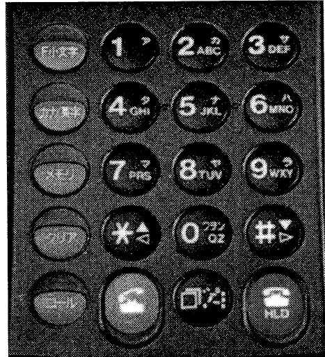
図 5: アメリカの電話機と同様のダイヤルパッド (NTT DoCoMo の携帯電話)
