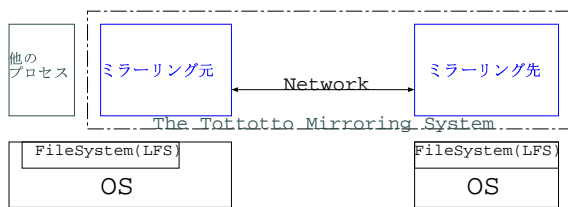
図 1 Tottotto ミラーリングシステムの構成 Fig. 1 Design of the Tottotto Mirroring System
