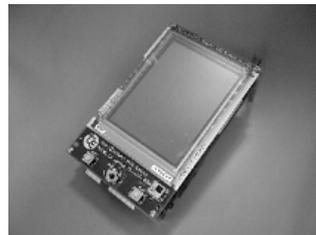
図 3: T-Engine/SH7727 開発ボード
