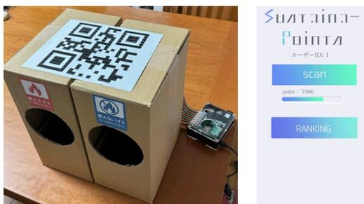
図 2 実装したゴミ箱とミニアプリの画面の例
