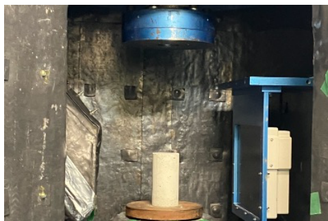
図1 X線CT装置の供試体の撮影の様子
