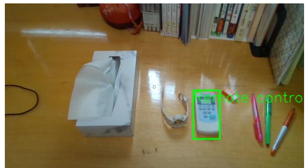
図2 MRHMD を用いた物体認識および自動翻訳処理結果
