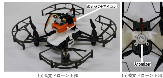
図2 嗅覚ドローン: (a)M5stickC とマイクロコントローラーを設置したドローン上部, (b) アドマイザーを設置したドローン下部.
