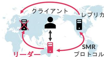
図1 SMR プロトコルの概要
