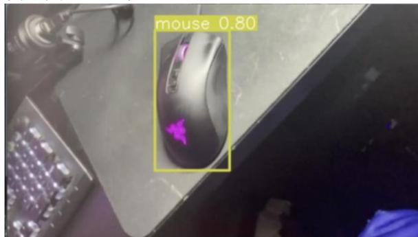
図3 物体認識モデルを用いてMRHMDの視野画像からオブジェクト領域を抽出した例
