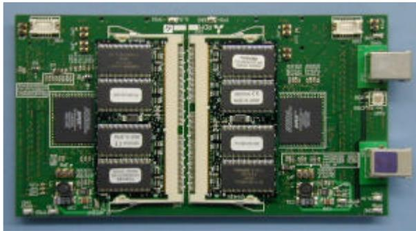
図 2.3 ドータメモリカードの外観
