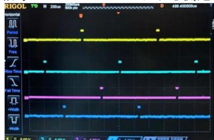
図 6 LED 信号のオシロスコープによる測定結果
