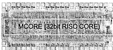
図15 MCore ハードマクロのレイアウトイメージ コア寸法 0.36x2.3mm/0.13um CMOS
