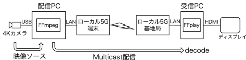
図14 4Kカメラ映像配信システムの配線図
