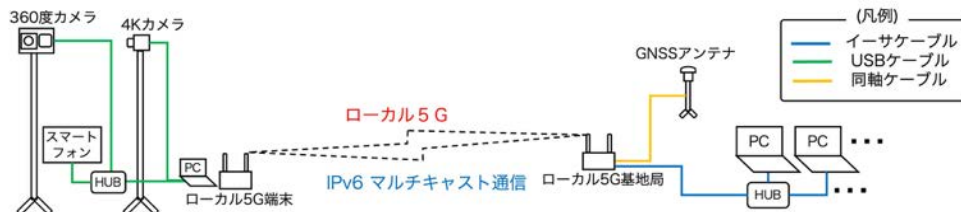
図12 4Kカメラ・360度カメラの配信システム概要図
