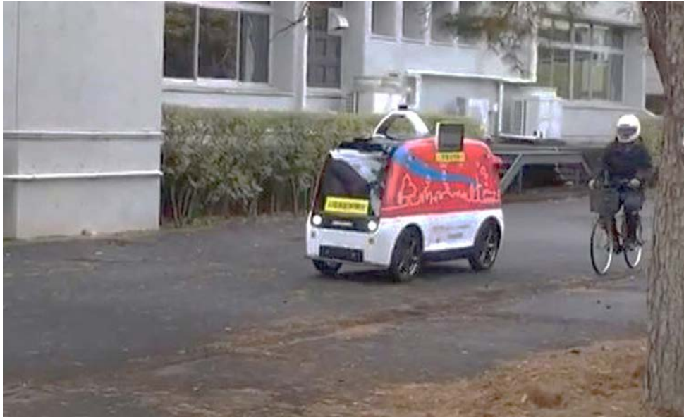
図6 自転車との安全試験の様子（早稲田大学構内）：左から追い抜こうとする自転車を想定した巻き込み試験
