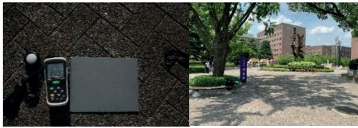
図2 標準反射板(左)と実測した地表日陰の例(右)
