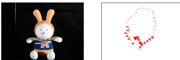
図2: 実験で用いたぬいぐるみの様子と、ぬいぐるみでカメラの位置や方向を推定しLEDの3次元位置推定をした結果。結果画像は、青い点がLEDの3次元点群で、赤いアイコンがカメラの位置と方向を示す。
