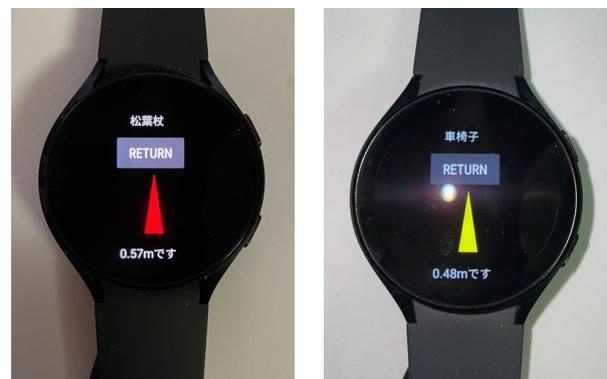
図 4: 通行不可なバリア情報の提示 図 5: 松葉杖のみ通行可能なバリア情報の提示
