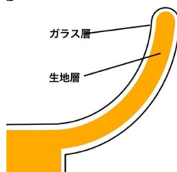
図1 陶磁器の断面（生地層とガラス層）
