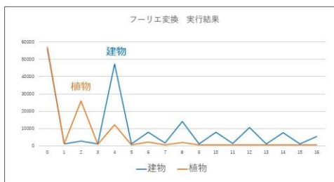
図6 特徴点の方向分布をフーリエ変換した結果
